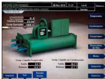
Figura 6. Visor de monitoramento do chiller de 750 TR em operação
