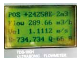
Figuras 8 (a e b). Medições de vazão dos ramais da praça de alimentação (a) e do pavimento superior (b).
