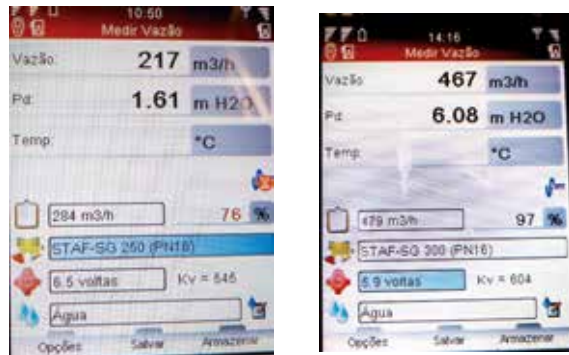
Figuras 4 (a e b). Medições de vazão de água gelada (a) e de condensação (b) no chiller de 750 TR
