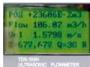
Figuras 8 (a e b). Medições de vazão dos ramais da praça de alimentação (a) e do pavimento superior (b).
