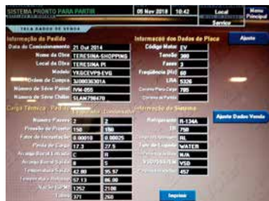
Figura 2. Tela de dados dos chillers de 750 TR
