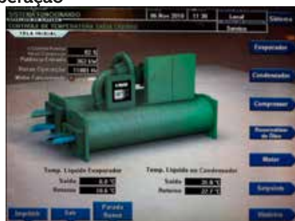
Figura 6. Visor de monitoramento do chiller de 750 TR em operação
