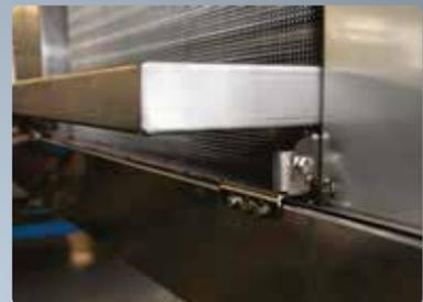
Suporte para apoio de escada para limpeza. Bandeja escamoteável com dobradiças reforçadas em inox.
