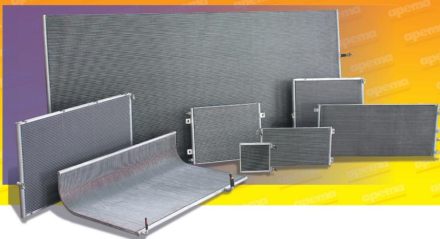
Os condensadores da linha CM resfriados a ar são equipamentos empregados em sistemas de refrigeração e ar condicionado, com a finalidade de rejeitar o calor adquirido no sistema evaporador. Sua tecnologia de microcanaís em alumínio permite, melhor performance, economia de gás refrigerante, tamanho reduzido e maior vida útil.
