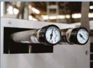
Equipamentos pressurizados com N2 e enviados com manômetros.
